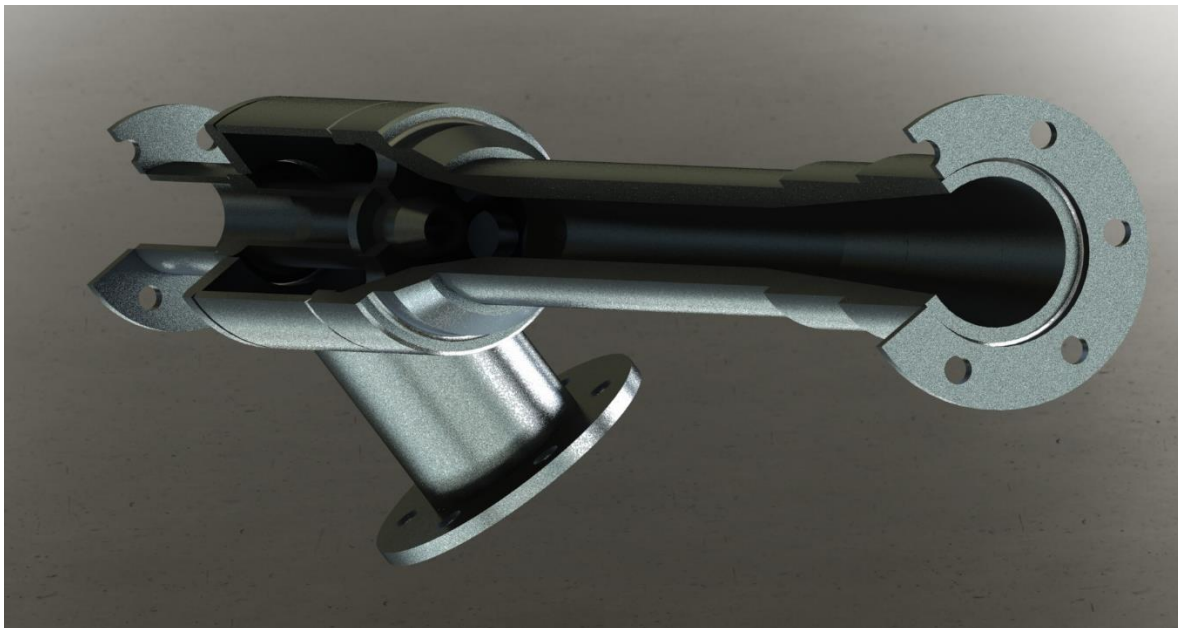
Сл. 6.8 Пресек со приказ на проточниот простор на ејекторот
