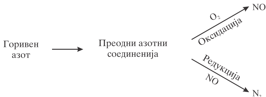
Слика 3. 13. Базичен (поедноставен) модел на формирање и деструкција на горивни NO x
