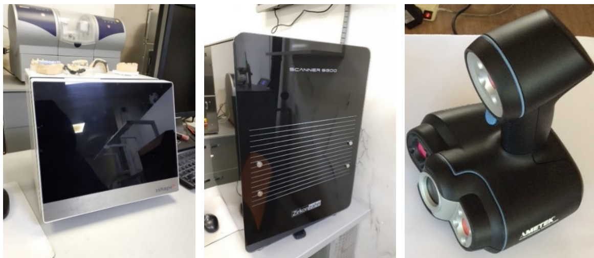
Слика 2.5: 3D скенери со техника на структурирана светлина: (лево) 3Shape D900; (средина) Zirkonzahn S600; (десно) Go!SCAN 3D.
