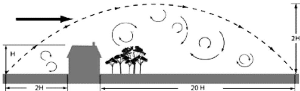
Слика 2.9. Турбуленции создадени од пречка (Извор: Bukała, J., Damaziak, K., Karimi, H. R., Kroszczyński, K., Krzeszowiec, M., Małachowski, J., A comparative analysis of popular modern small wind turbine design solutions in terms of estimated cost to power output ratio, Turbomachinery, 2014.)
